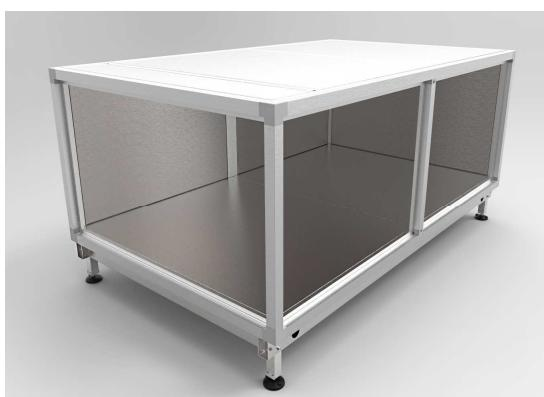
Kućište klima komore urađeno je od ekstrudiranih aluminijumskih profilima i rogljevima, sa oplatama (sendvič paneli sa ispunom od izolacionog materijala). Izolacioni materijali mogu biti: poliuretan gustine  $44\text{kg/m}^3$  ili kamena mineralna vuna gustine  $90\text{kg/m}^3$  sa poprečno orjentisanim vlaknima između limova.
