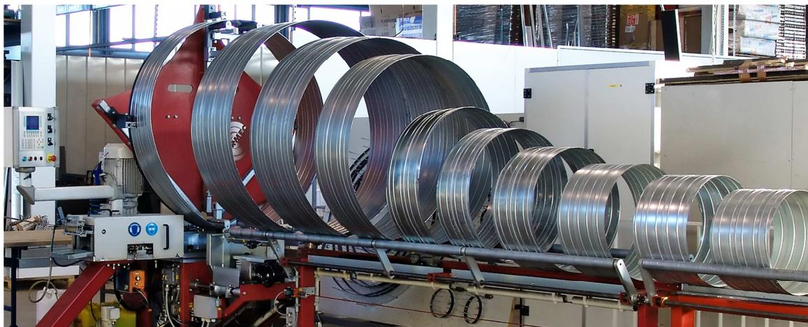
Proizvodnja spiro kanala i fazonskih elemenata se odvija na najsavremenijim visoko kvalitetnim mašinama i alatima. Svi elementi u sistemu spiro kanala su standardizovani.
