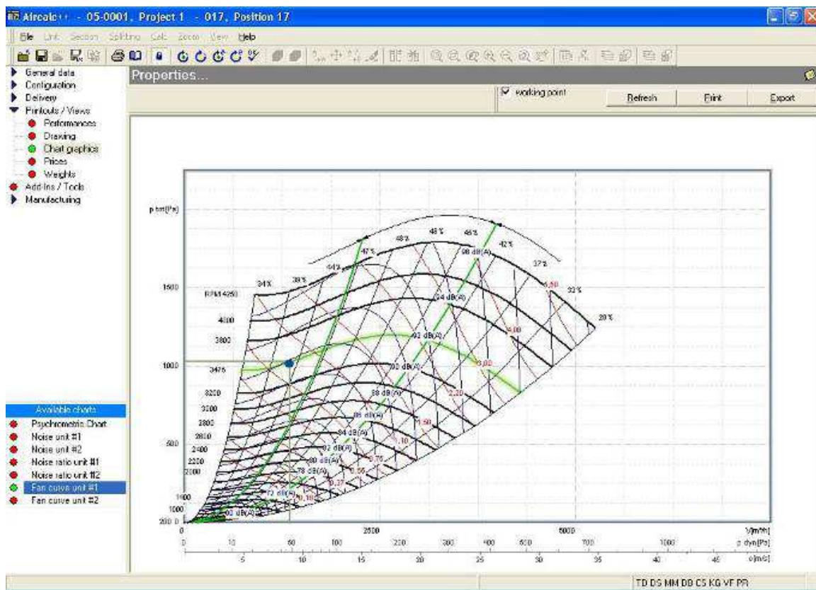
Ovaj dijagram prikazuje karakteritiku ventilatora sa položajem radne tačke ventilatora. Program pravi zasebne dijagrame karakteritika ventilatora za svaku jedinicu uređaja (Karakteristika ventilatora jedinica #1, Karakteristika ventilatora jedinica #2)
