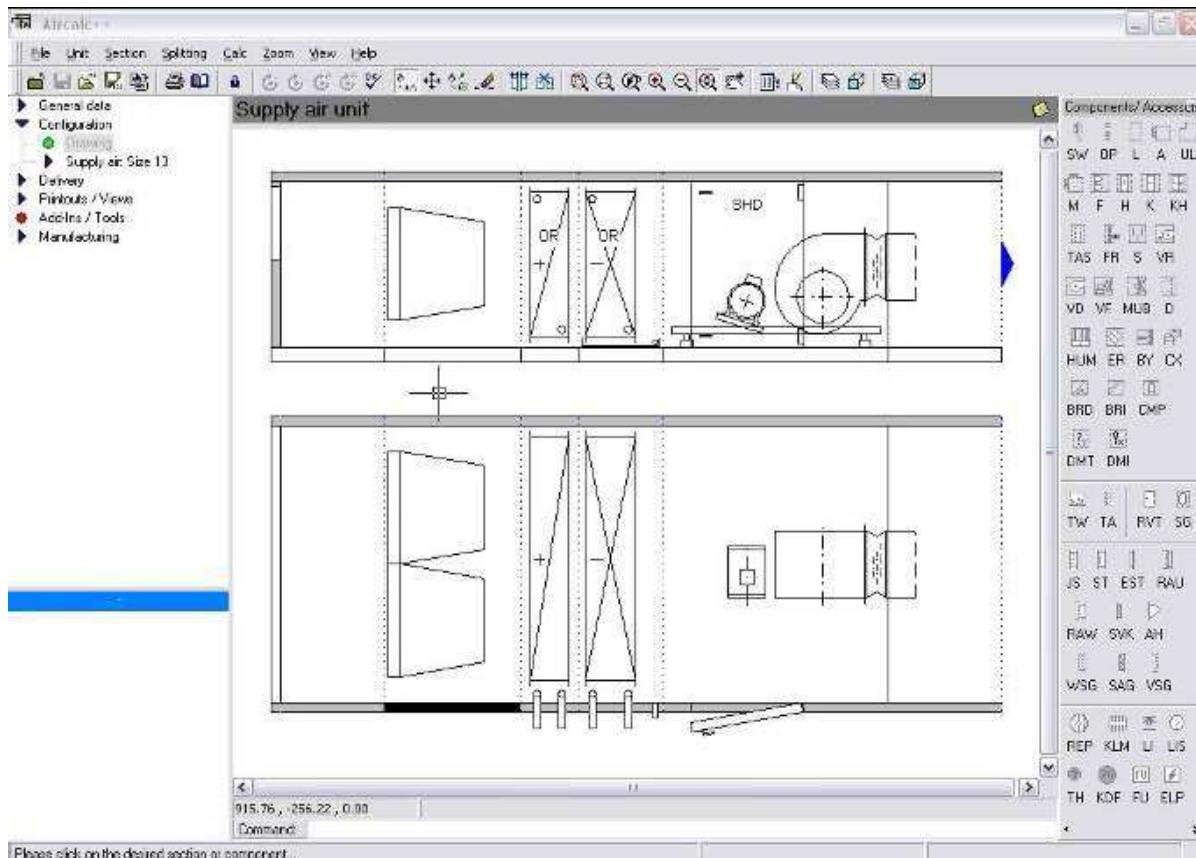
Ukoliko ste konstruisali čitav uređaj, možete još dodati i dodatke na otvore kao npr. regulacijske dempere, elastične veze, protiv kišne rešetke itd. Kliknite na odgovarajući simbol na meniju a potom na željeni otvor. Program je sada u modelu "ponavljanja" – svaki daljnji klik levom tipkom miša na druge otvore ubacuje istoimenu komponentu. Izlazak iz modela ponavljanja obavlja se klikom na desnu tipku miša negde na praznoj podlozi programa, blizu samog uređaja.
