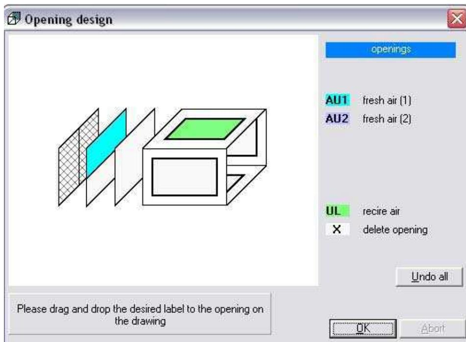
Pri izboru usisne/potisne ili mešajuće sekcije, potrebno je definirati položaj pojedinog priključka. Jednostavnim klikom izaberite željenu poziciju ili Prevuci i Spusti (Drag & Drop) metodom željenu boju vazduha (prikazano sa desne ekrana) pozicionirajte na crtežu. Kod dvostrukih mešajućih sekcija (kombinovani klima uređaji) možete izabrati otvore pritiskom na levu ili desnu tipku miša.
