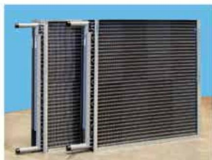
Standardno svi ovi razmenjivači su izrađeni od bakarnih cevi orebrenih sa aluminijumskim lamelama na određenim razmacima. Sabirne cevi su čelične (sa priključcima na navoj ili prirubnice) ili bakarne na lemljenje. Razmenjivači su opremljeni sa priključcima za odzračivanje i ispuštanje vode. Jedinice hladnjaka su opremljene otkapnom posudom (sa izolacijom sa donje strane) i priključkom za sifon. Iza hladnjaka se postavlja eliminator kapljica za brzine vazduha preko hladnjaka veće od 2,2 m/s.
