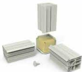
**Okvir kućišta** rashladnih komora je sa rastavljivom konstrukcijom od PVC profila i uglova. Specijalnog oblika sa zaobljenjima radi lakšeg čišćenja, tako da su zadovoljeni HACCP standardi. Koristimo PVC profile i uglove u dve veličine zavisno od veličine i namene rashladne komore. Rashladna komora se isporučuje u delovima i montira na objektu.
